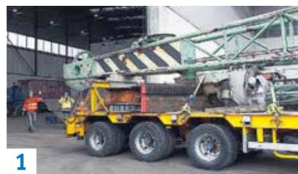
**1** Die längsten Bauteile waren über 15 Meter lang und wurden auf Spezial-Tiefloadern ins Loacker Swiss Werk Birmensdorf (ZH) geführt. Projektleiter Peter Wurzer weist das Fahrzeug ein.
