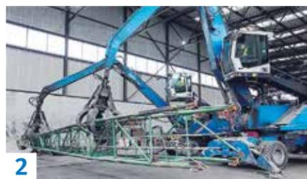
**2** Große Bauteile wurden mit zwei Fuchsbaggern synchron abgeladen.
