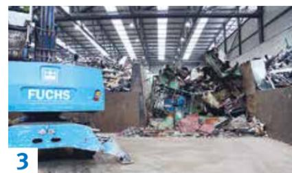
**3** Die Anlieferungen wurden umgehend mit dem 600-Tonnen-Beiß-Bagger vorzerkleinert und vor der Schrottschere zwischengelagert.
