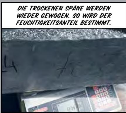
DIE TROCKENEN SPÄNE WERDEN WIEDER GEWOGEN. SO WIRD DER FEUCHTIGKEITSANTEIL BESTIMMT.
