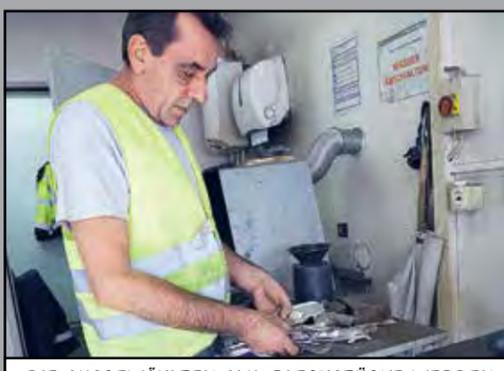
DIE AUSGEWÄHLTEN ALU-BLECHSTÜCKE WERDEN ANSCHLIEßEND VON WOLFGANG FÜR DIE SCHMELZANALYSE VORBEREITET.
